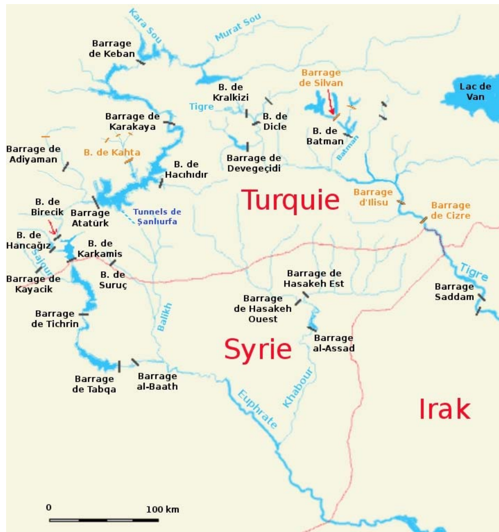
Carte n°3 : Carte des ouvrages hydrauliques du bassin supérieur du Tigre et de l'Euphrate 8 Les barrages dessinés en orange sont des projets
