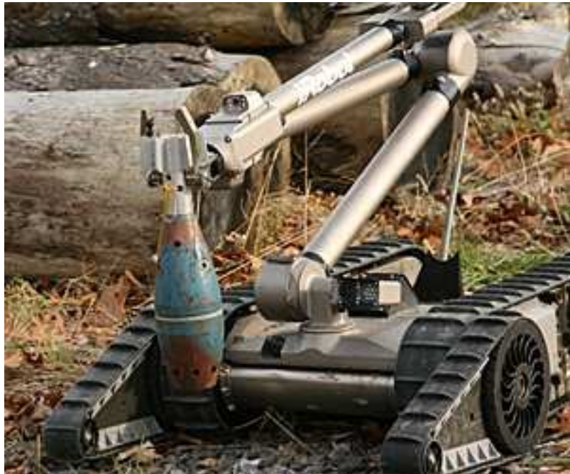
UGV : PackBot en opération de déminage, page 7
