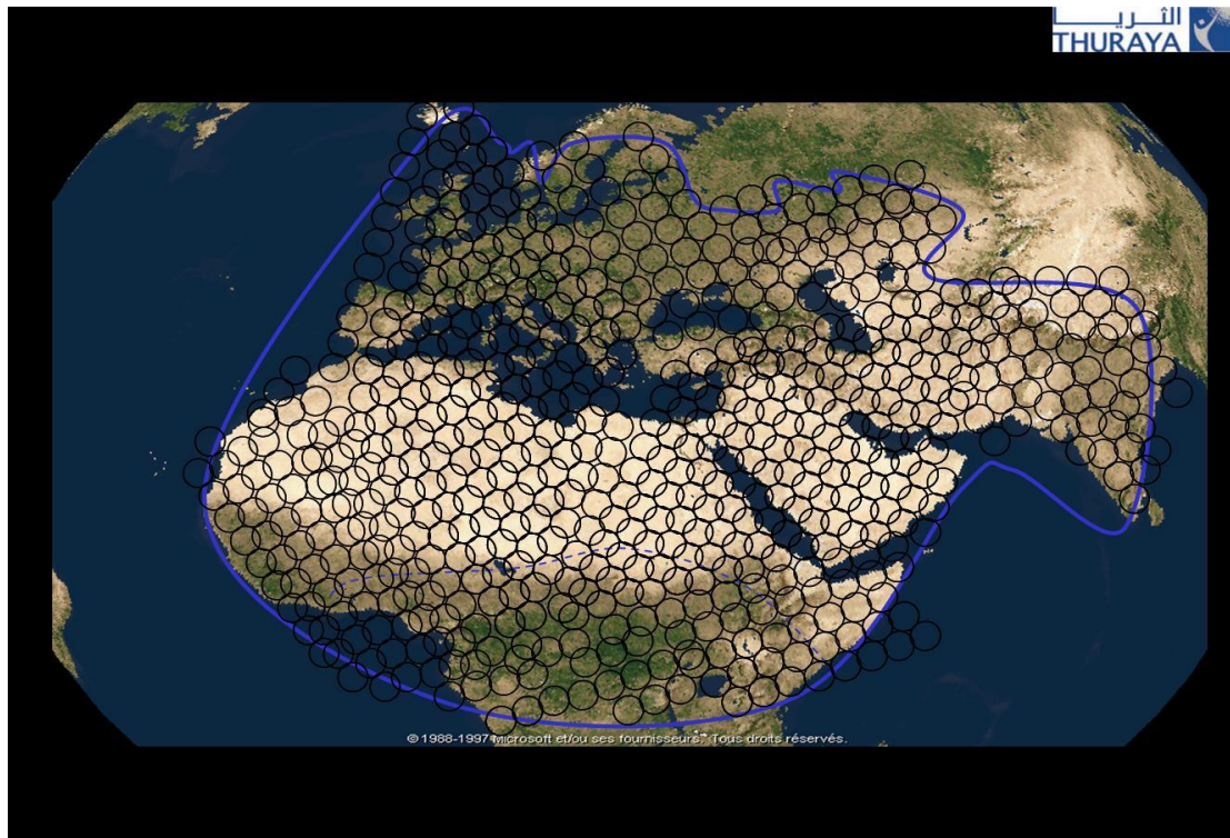
Figure : Les « spot beam » de Thuraya. Chaque cellule a un diamètre de l'ordre de 200km.
